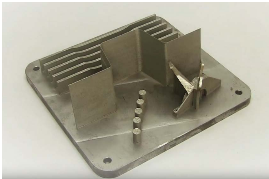
Figura 19. Ejemplo de fabricación aditiva en metal. Pieza final. Fuente: [28]
