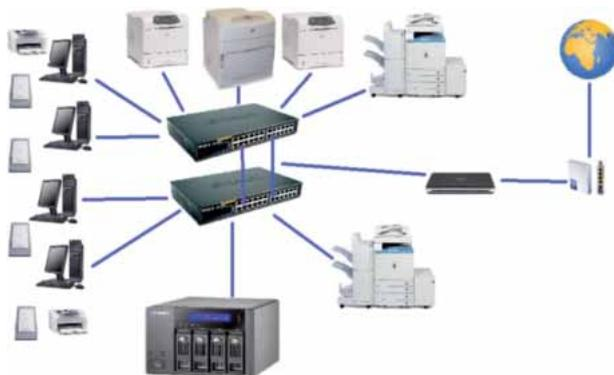
impresión, DHCP, servidor de correo, firewall, intranet, software de gestión bibliotecaria y Microsoft SharePoint para uso interno), que a su vez están conectados a una línea de cable de fibra óptica para la entrada/salida de Internet a través de banda ancha. Dentro del sistema informático hay establecidas distintas zonas de seguridad mediante el firewall y los switches instalados, existiendo zonas de acceso exclusivo a Internet y zonas de acceso a la red del CES.
